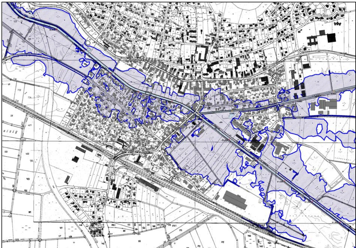
Abbildung 5: Berechnete Überschwemmungsgebiete des 100-jährlichen Hochwassers
