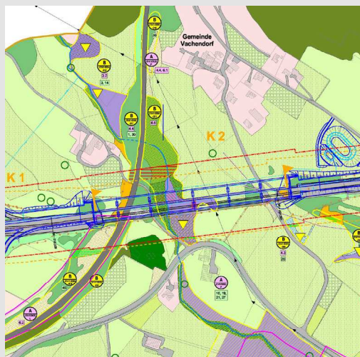
Geplante Brücke und bestehende Nutzung
