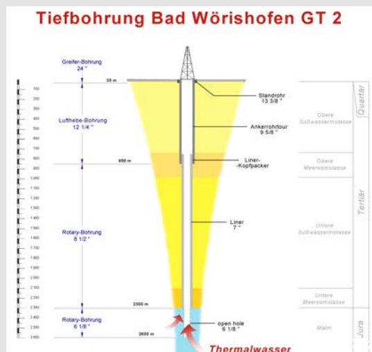
Schematische Darstellung der Tiefbohrung GT 2 (li.) und Bohrturm für die Tiefbohrung (re.)
